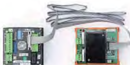
DIN type «report relay» M0901 card connected J1900 panel
